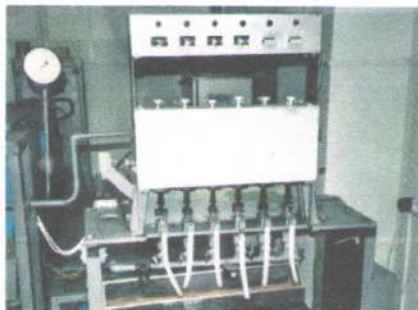
Стенд для испытания вентиляных головок
