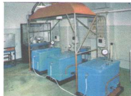
Стенд для определения стойкости труб из полимерных материалов и их сборных узлов при постоянном давлении при температуре от 20 до 95 °C
